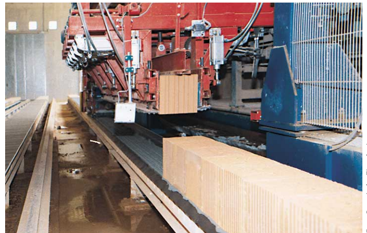
So produziert FMS: Vollautomatisch werden die Ziegelsteine von einem Greifer auf das Band gestellt und fest ins vorbereitete Mörtelbett gedrückt.
