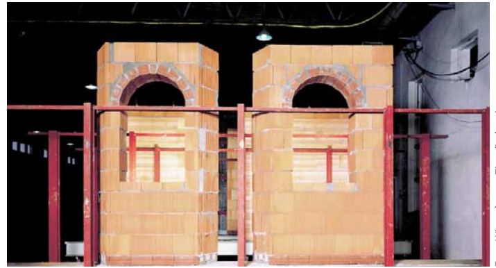
Ziegelelemente können werkseitig sehr individuell gestaltet werden, hier ein Beispiel aus dem Werk Reuden: fertig eingemauerte Rundbögen.
